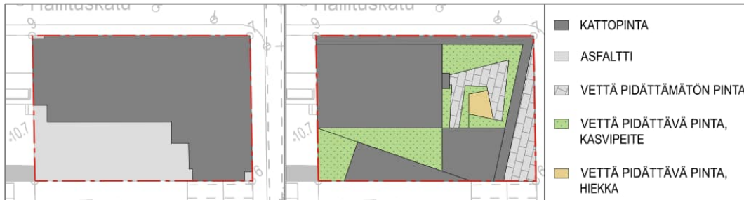
Kuva 6. Hulevesilaskennassa käytettyjen pintojen sijoittuminen selvitysalueella nykytilanteessa (vas. ruutu) sekä rakentamisen jälkeen (oik. ruutu). Perustuu asemapiirustukseen (kuva 5) sekä rakennuksen pohjapiirustuksiin.
